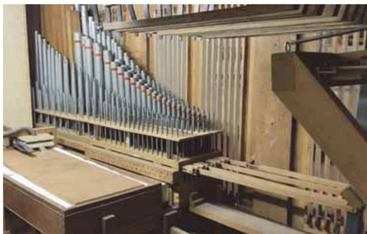
Das geräumige und begehbare Unterwerk mit leider nur vier Registern. Zu sehen ist links der Windbalg, der für vollkommen gleichbleibenden Luftdruck sorgt. Daneben die Windlade mit den vier Registerschleifen und den vier Trakturen hin zu den Registerzügen rechts im Spielschrank. Auf dem Pfeifenstock die Pfeifen der vier Register.
